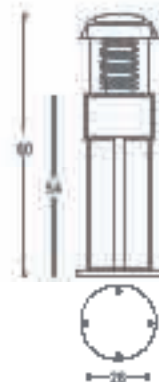
fori per fissaggio mediante tirafondi
