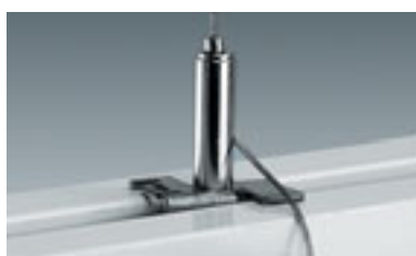
Тросовый подвес «С» с регулировкой по высоте, с тросом, с петлей сверху Трос: Диам. = 1,5 мм Несущая способность: 16 кг
