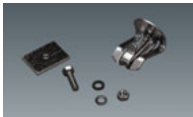
Универсальный подвес для светильников для троса ( \phi \leq 4,5 мм) или цепи ( \phi_{\text{внутр.}} \geq 7,5 мм) Несущая способность: 25 кг
