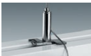
Тросовый подвес «С» с регулировкой по высоте, с тросом с петлёй сверху Трос: Диам. = 1,5 мм Несущая способность: 16 кг
