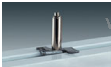
Тросовый подвес «В» с регулировкой по высоте, без троса (для троса: Диам. = 1,5 мм) Несущая способность: 16 кг
